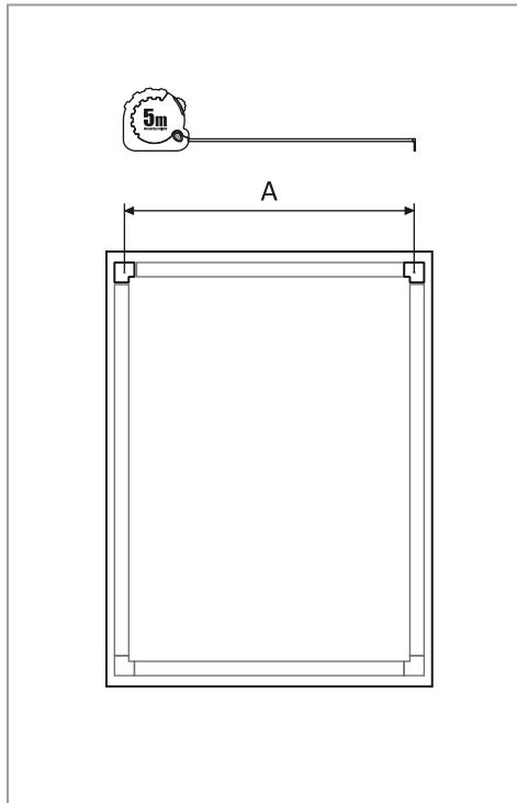
3. Перенести полученные размеры на поверхность стены и отметить две точки для сверления.
