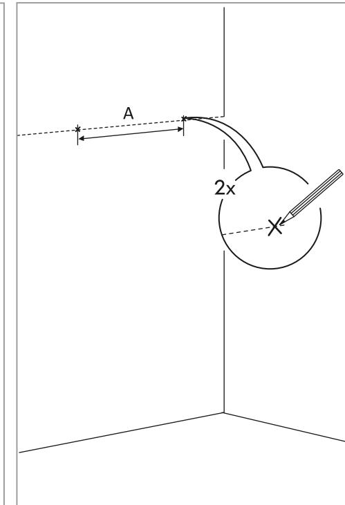
4. Просверлить отверстие буром по бетону диаметром 8 мм в отмеченных точках.
